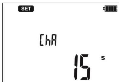
Следующее нажатие клавиши **SEL** переводит в режим установки интервалов **ChA** для временных характеристик изоляции  $R_{ISO}$ . Клавишами  $\Delta$  и  $\nabla$  установите интервал времени (15, 30 или 60сек.). Горизонтальные штрихи на дисплее обозначают невозможность записи данных.
